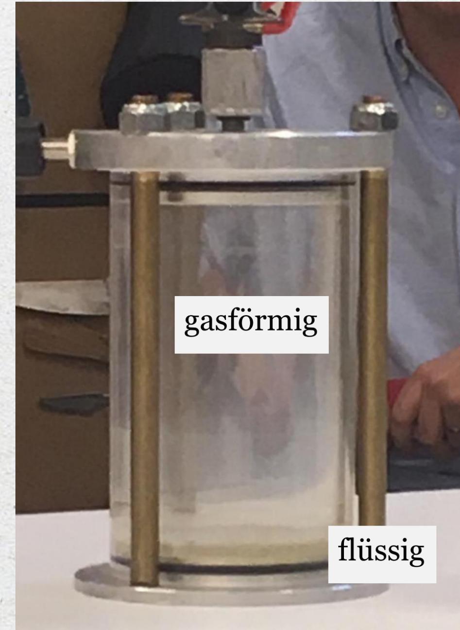
Flüssiges Gas “siedet”, gasförmiges Gas tritt nach oben aus und verbrennt
